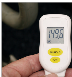
Kontrolle der Mischguttemperatur
